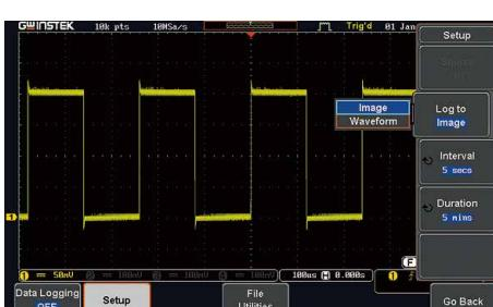
GDS-1000B 示波器具备选配资料记录器功能，其功能可让使用者长时间观测纪录波形的变化以确保产品的可靠度以及稳定性。资料纪录功能可依测试需求，设定储存档案的期间与间隔。纪录时间可选择 5 分钟至 100 小时；储存间隔最短为 5 秒。储存资料可选择储存波形或是点资料 CSV 档案。储存的资料亦可选择存于 USB 随身碟、GDS-1000B 内部或是透过 LAN 储存于远端的计算机内，是一个即为人性化的进阶量测管理工具。
