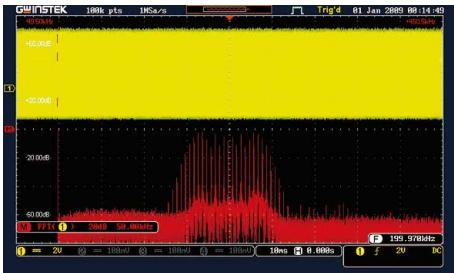
GDS-1000B 系列示波器在快速傅立叶转换的数学分析模式中具备了 1M 记忆长度撷取模式。在传统的各系列数字示波器当中，FFT 模式通常只具备 1000 点的撷取长度，所以在频域模式的表现上较不能呈现各频谱量的强度分布细节，但是今天 GDS-1000B 系列示波器率先提供了 1M 撷取点的显示模式，不但能清楚地表现频谱量的显示细节，同时加上高达每秒 110,000 次的波形更新率，使得 FFT 分析模式就如同在使用一台实时频谱分析仪一般的快速而精准，大幅提升了示波器在频域分析的信号处理能力。图中是一个载波为 200KHz、调制为 40KHz 以及频偏为 5KHz 的标准调频信号，因为 GDS-1000B 具备了 1M 撷取的记忆深度，所以 5KHz 的频偏间隔可以清楚地显示出来，让工程师可充分地掌握量测的细节。
