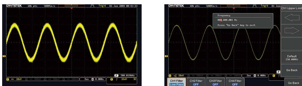
在电路的测试中，工程师在测量信号时经常被噪音干扰困扰。GDS-1000B 系列示波器提供了数字滤波功能选项，该选项可以设置各个通道为高通或低通滤波器。滤波器的频率可以根据需求调整。滤波器每个通道的参数还可以设置跟踪，可用于设置滤波器频率相同所有频道。
