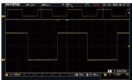
当工程师在观察细微的波形量测时，GDS-1000B 示波器提供了波形局部放大的功能，将其视窗分成上下两个部分，上面视窗为长时间波形的资料记录以及标示着需要放大波形的位置关系，下方的视窗则是局部波形的放大图示，这不仅能够提供观察者相对波形的比较，亦能详细地掌握不同时间点之波形细节。另外，GDS-1000B 也同时提供了播放 / 暂停的功能。特别是在长时间的波形监控时，播放功能能帮助工程师快速地浏览整段待测之波形，亦能快速地寻找出波形问题之所在。
