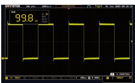
一般研发工程师在进行电路量测以及除错时，不仅需要用到示波器，基础电表也是必备的工具之一。GDS-1000B 示波器具备数位电压表的功能，提供三位电压表及五位频率计的功能工程师只要按下选配的按键，即可在选单中将数位电压表的功能叫出来。其可实时地量测直流、交流电压，占空比以及频率，让工程师除了可以量测波形之外，亦能监控电路板上各元件的电气参数特性，实在是一个非常方便的工具。
