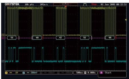
如今，数字通信协议是繁荣的时代。串行总线的测量已经逐渐成为开发人员和设计人员的标准。GDS-1000B 系列示波器可选配串行总线解码功和分析功能，包含 SPI,I<sup>2</sup>C,CAN,LIN 和 UART 协议，不仅提供完整的触发方式和解码分析功能，还能调整每个通道的逻辑水平。提供给工程师一个简单实用的逻辑分析工具。
