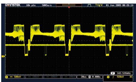
GDS-1000B 系列示波器在波形显示技术上可呈现 256 色阶之显示技术。在信号多样化的量测世界中更能勾勒出丰富的层次变化，彷彿将模拟示波器的显示能力再度表现出来。当输入一个多层次变化的影像信号时，具备 256 色阶显示的 GDS-1000B 示波器能够将丛发信号明确地表现出来，且能够以 256 色阶之变化呈现亮度的层次细节。
