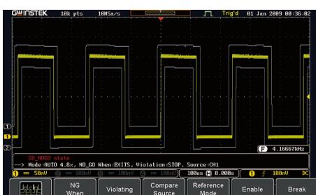
在产业界量产品时，产品的良率判定成了一个重要的课题。GDS-1000B 示波器提供了 Go/NoGo 分析功能，目的就是加速产品的良率分析。如右图所示，对于一个待测波形而言，Go/NoGo 分析功能可以提供一个标准的波形模板，其可随心所欲地调整模板的大小，只要待测波形出现异常状况而碰触到模板时，就会产生不良品的讯息，这不仅提供了产线生产一个重要的量测利器之外，对于研发工程师来说，Go/NoGo 功能针对长时间地监控待测波形也是非常方便的工具。
